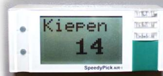
Für die Anbindung der Anzeigen wurde SpeedyPick Air in das ERP-System von Polo Motorrad integriert. Über eine Schnittstelle signalisieren diese nun den Behälterbedarf an einem bestimmten Standort. Das ERP-System verarbeitet diese Anforderung und leitet diese über eine weitere Schnittstelle an die SPS-Steuerung der Fördertechnik-Anlage weiter:
